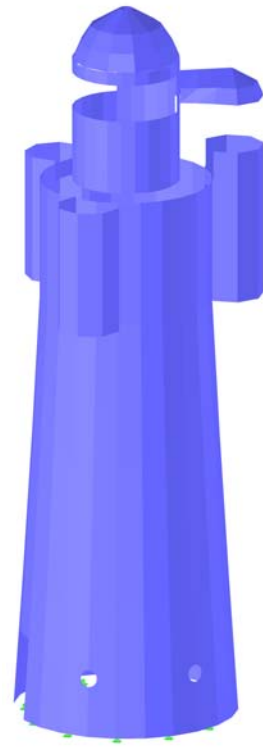
Abb. 3 Isometrie Blechmantel ohne Stabwerk (Blick von S/SSO)
